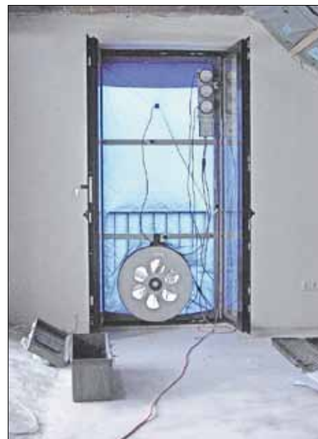
Apparatur zur Luftdichtheitsmessung Foto: VZ RLP
