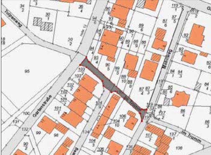
Abb. 2 Deckensanierung - ca 80m 2 Am Ende der Wiesenstraße sind Asphalt Versprödungen zu erkennen. In einem Bereich von ca 80m 2 soll nur die Asphaltdeckschicht abgefräst und erneuert werden.
